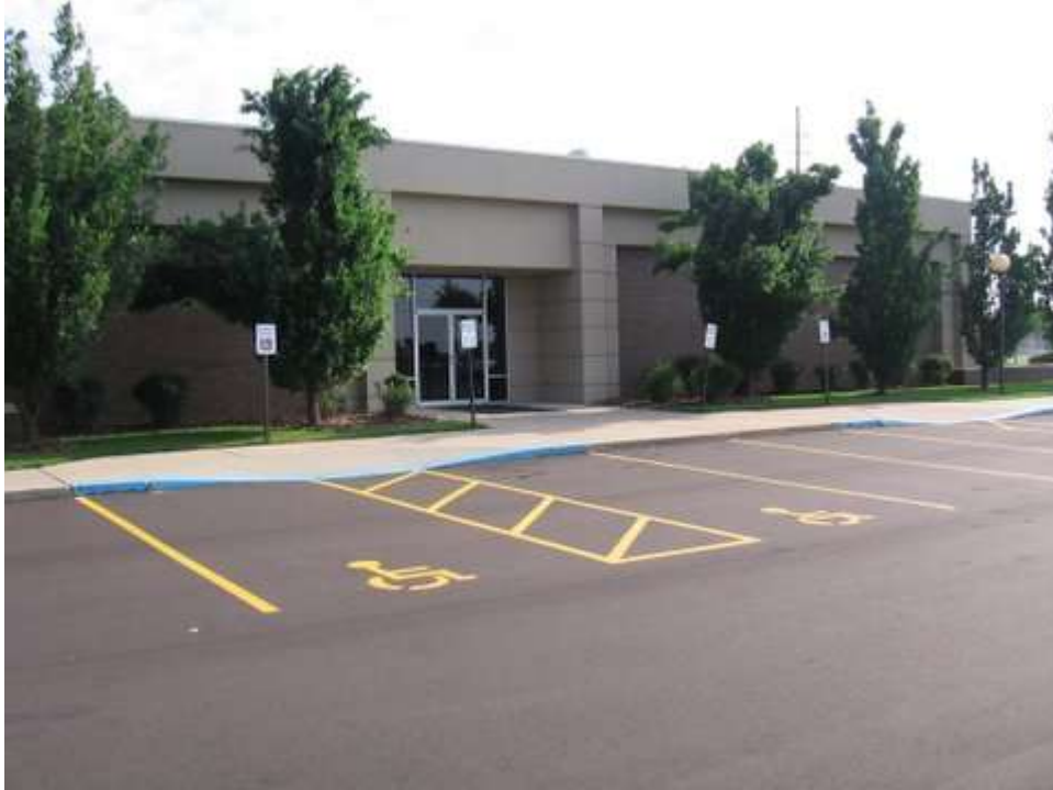
Şekil 5.9 Doğru şekilde işaretlenmiş, yaya yoluyla doğrudan bağlantılı ve girişe en yakın konumda ayrılmış park alanı örneği 28
