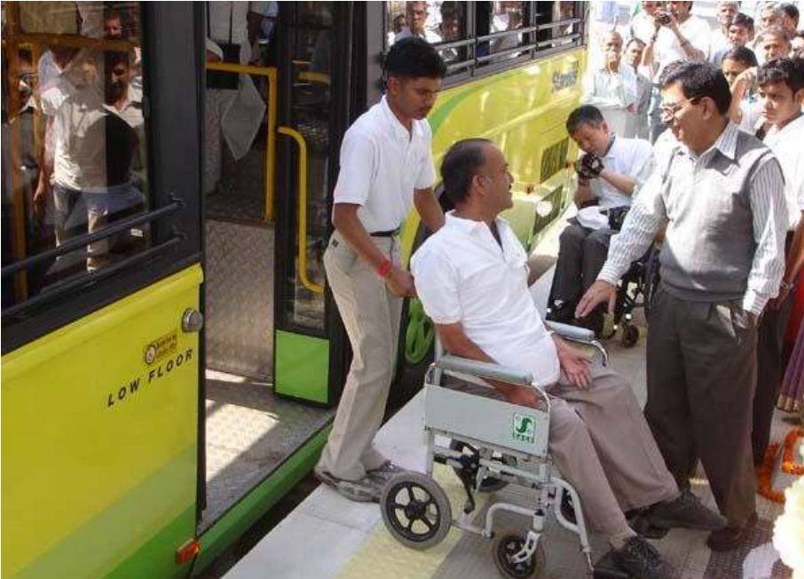
Şekil 5.4 Yeni Delhi'de, zemini otobüsün zemininin seviyesiyle eşitlenmiş bir otobüs durağı 23
