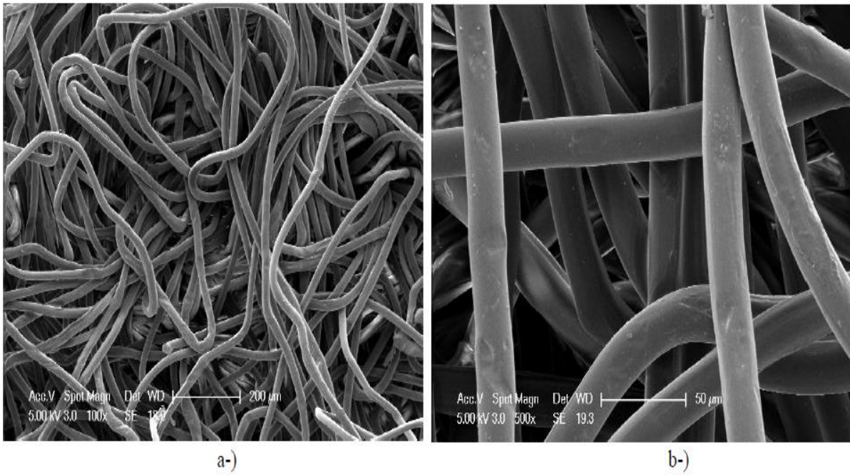
Şekil 5. Plazma ile muamele edilmemiş PP filtrelerin a) x100 büyütme b) x500 büyütmede SEM görüntüleri
