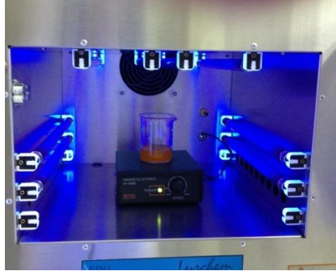
Şekil 2. Fotokatalitik deneyler için kullanılan fotoreaktör
