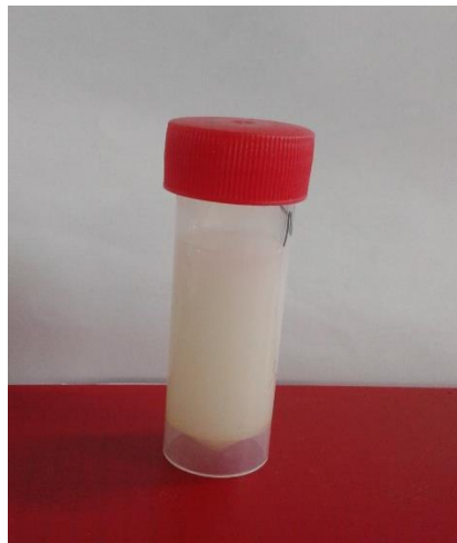
Şekil 12. Kaplama için hazırlanan koloidal \text{TiO}_2 nanotüp
