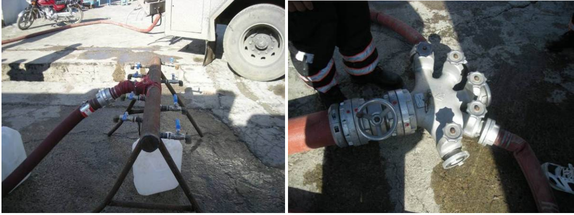
Şekil 5.54. Beş ağız çıkışlı sistemle ve 8 musluklu su dağıtım elemanı
