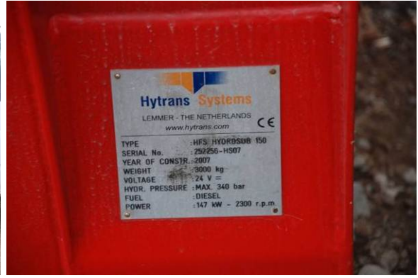
Şekil 5.51. 147 kW gücünde ve 8600 lt/dk kapasiteli iki jeneratör beslemeli pompa
