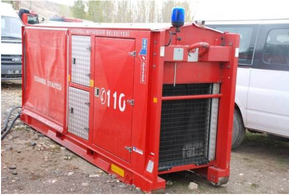
Şekil 5.51. 147 kW gücünde ve 8600 lt/dk kapasiteli iki jeneratör beslemeli pompa
