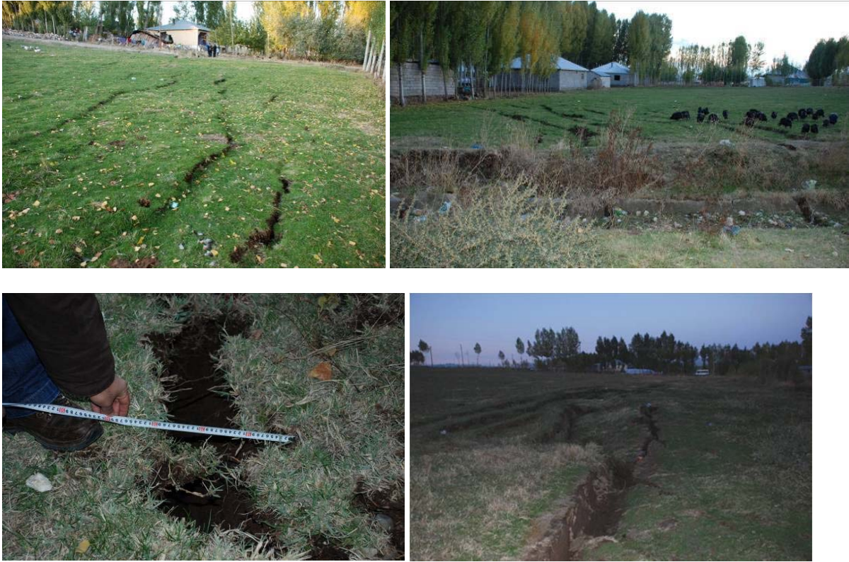
Şekil 4.10. Erciş, Çelebibağı - İnönü Mahallesi yanal yayılma (İnce kum ve yüksek yeraltı su seviyesi)
