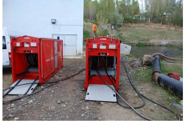
Şekil 5.50. Su kaynağı ve terfi sistemini sağlayan iki jeneratör beslemeli pompa
